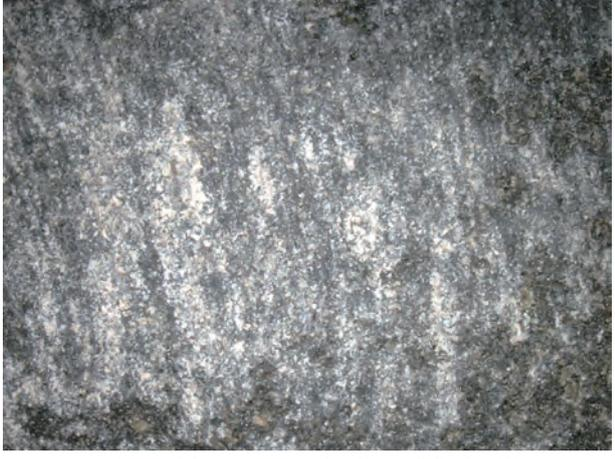
写真6 砂岩サンプル・研磨回数800往復 (25倍)
