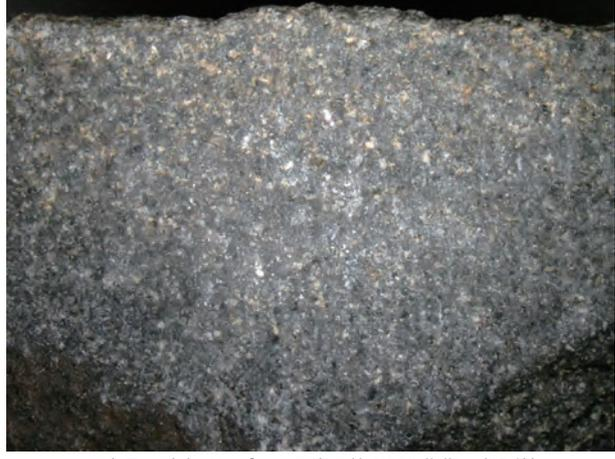
写真7 砂岩サンプル・研磨回数1,000往復 (25倍)
