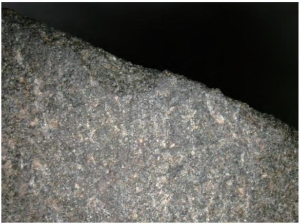
写真2 砂岩サンプル・研磨回数50往復 (25倍)
