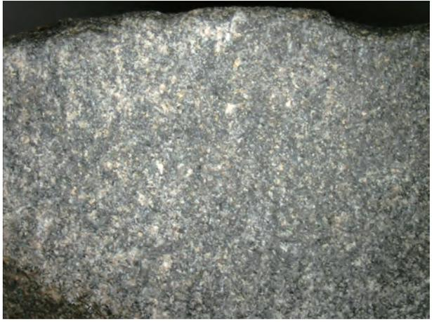
写真4 砂岩サンプル・研磨回数400往復 (25倍)
